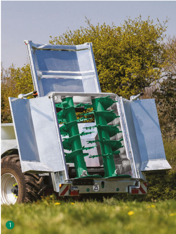
1 | Puerta guillotina hidráulica
