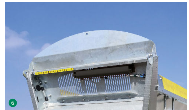
5 | Indicador mecánico de apertura de la guillotina
